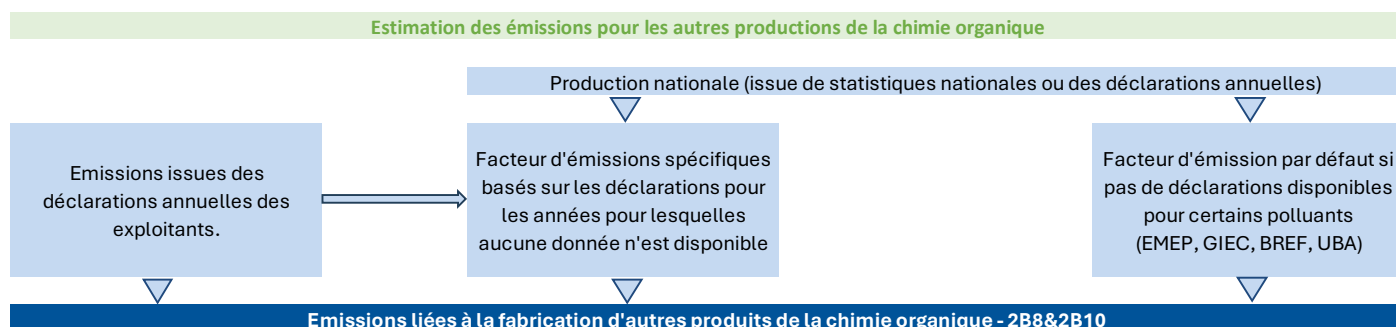
Figure 8 : Logigramme du processus d'estimation des émissions de polluants pour les autres productions de la chimie organique – 2B8&10
